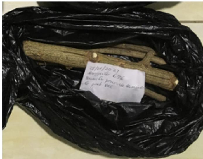
Figure II 36 : Echantillon de branches (< 3 cm et  $\geq$  1 cm) avec l'étiquette pour le laboratoire
