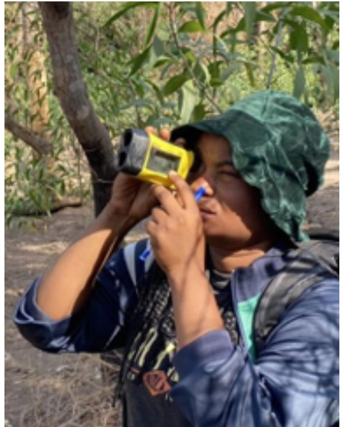
Figure II 4 : Utilisation d'un dendromètre à rayon de laser pour mesurer la hauteur des acacias
