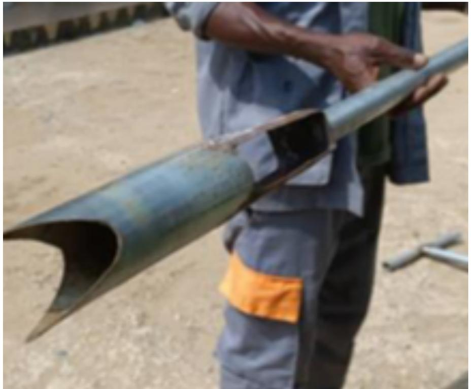
Figure II 15 : A gauche : Enfoncement d'un carottier pour le prélèvement d'un échantillon du sol. A droite : Vue en détail d'un carottier de fabrication locale
