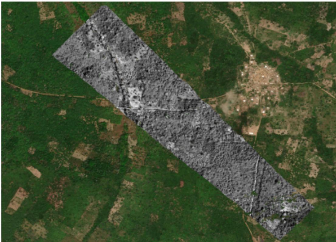
Figure IV 36 : L'orthophoto traitée superposée sur une image satellite de Bing maps . L'examen des routes sur les deux images montre que l'orthophoto n'est pas encore géoréférencée avec précision.
