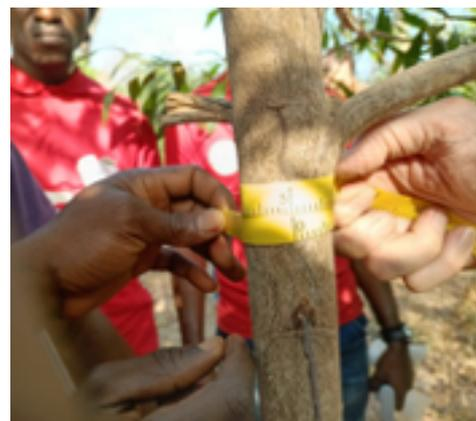
Figure II 2 : Mesure de diamètre à hauteur de poitrine.
