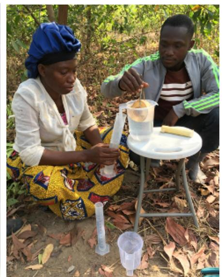
Figure II 34 : Mesure du volume d'un échantillon de bois par la méthode de déplacement d'eau
